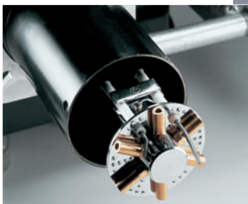
Testa a Basso NOx - Low NOx combustion head - Tête a bas NOx
